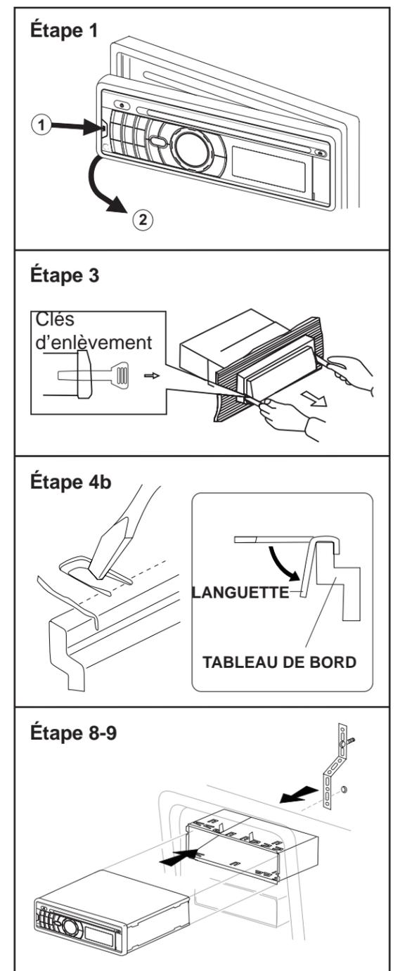
*A NOTER : Pour une bonne opération du lecteur CD/DVD le châssis doit être monté dans 20° de l'horizontal. Assurez-vous que l'appareil est monté à l'intérieur de cette limitation.*
