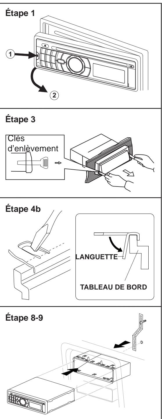
*A NOTER : Pour une bonne opération du lecteur CD/DVD le châssis doit être monté dans 20° de l'horizontal. Assurez-vous que l'appareil est monté à l'intérieur de cette limitation.*
