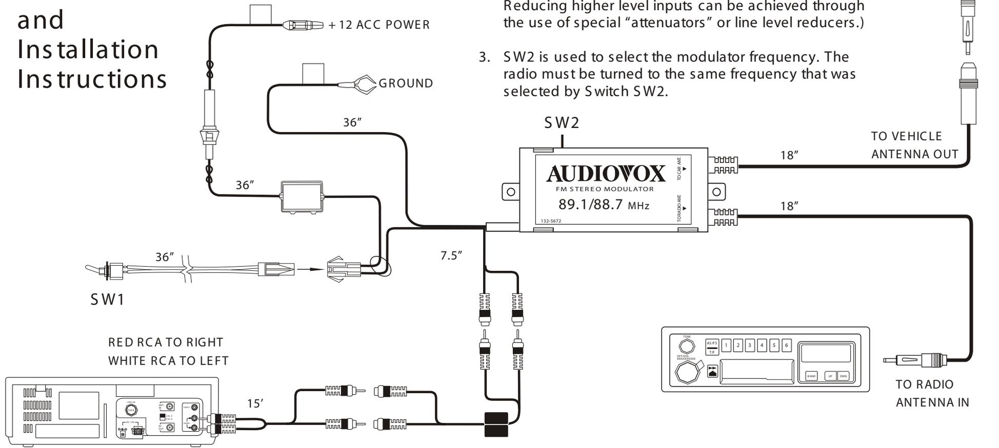
RCA PATCH CORD REQUIRED FOR STEREO CONNECTION
