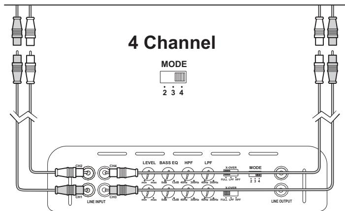
**NOTA:** El uso de cables RCA de buena calidad es tan importante como los cables de energía o altavoces. Elija un cable de alta calidad y baja impedancia para mejores resultados.
