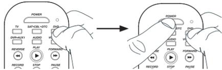
3. Espere hasta que el indicador LED del control remoto se ilumine y permanezca iluminado. Luego, suelte ambas teclas.
