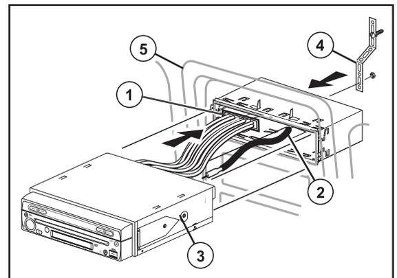
**CAUTION!** L'arrière de la radio doit être soutenu avec la courroie pour empêcher l'endommagement au tableau de bord depuis le poids de la radio ou de l'opération mauvaise à cause de la vibration.
