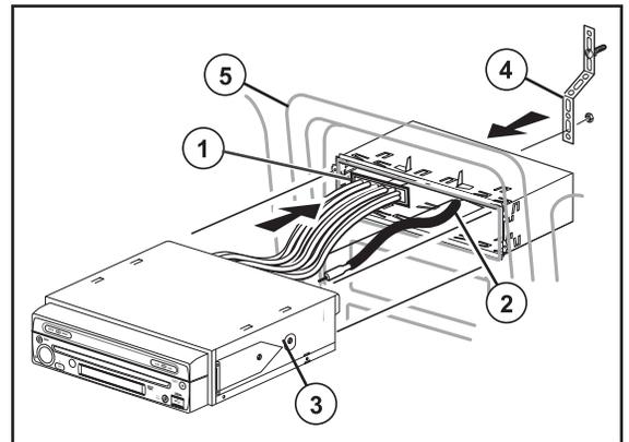
*¡PRECAUCIÓN! La parte posterior de la radio debe estar soportada con la tira para evitar daños a la consola por el peso de la radio o el funcionamiento inadecuado debido a la vibración.*
