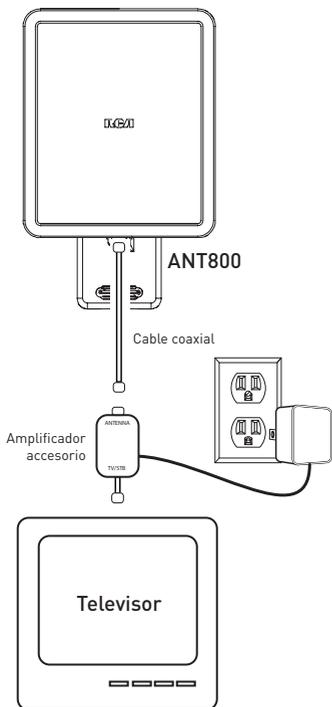
1. Tienda un cable coaxial RG6 desde la antena hasta el televisor. Acople el cable coaxial RG6 en el conector ANT del amplificador accesorio que se proporciona.
