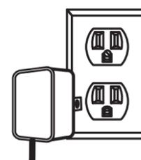
**Importante:** Este adaptador de alimentación deberá estar enchufado de forma tal que permanezca en posición vertical o apoyado de forma plana.
