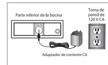
1. Inserte la clavija redonda, pequeña del adaptador de corriente CA de la bocina en el receptáculo DC IN en el panel inferior de la bocina.
