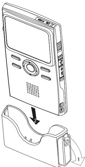
1. Tirez la languette de la fixation pour trépied pour ouvrir le verrou.
