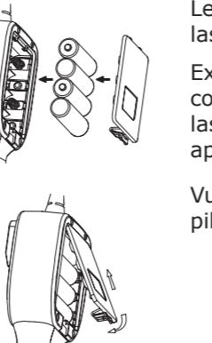
Levante el pestillo de la tapa del compartimiento de las pilas ubicado en la parte posterior de la cámara. Extraiga la tapa del compartimiento de las pilas y coloque 4 pilas "AA" (no incluidas). Asegúrese de que las pilas coincidan con las polaridades "+" y "-" que aparecen indicadas en el interior del compartimento.
