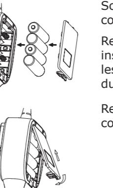
Soulever le loquet situé sur le couvercle du compartiment des piles à l'arrière de la caméra.
