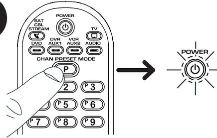
Oprima y sostenga la tecla P. La tecla POWER se ilumina. Continúe oprimiendo la tecla P hasta que la tecla POWER parpadee una vez y permanezca encendida. Luego suéltela.
