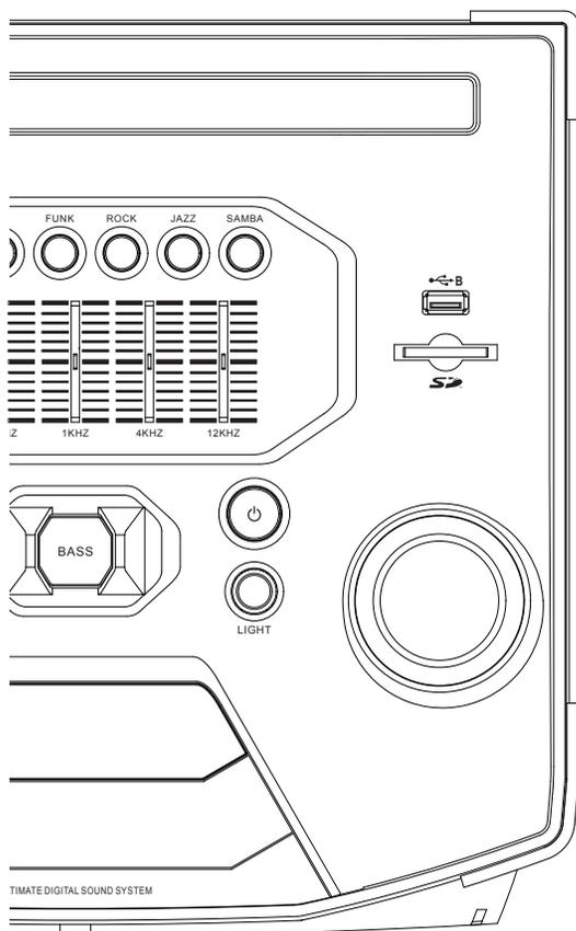
**Le bouton BASS** active l'augmentation du volume des basses et le spectacle de lumière. Appuyer pour activer/désactiver l'amplification des basses.
