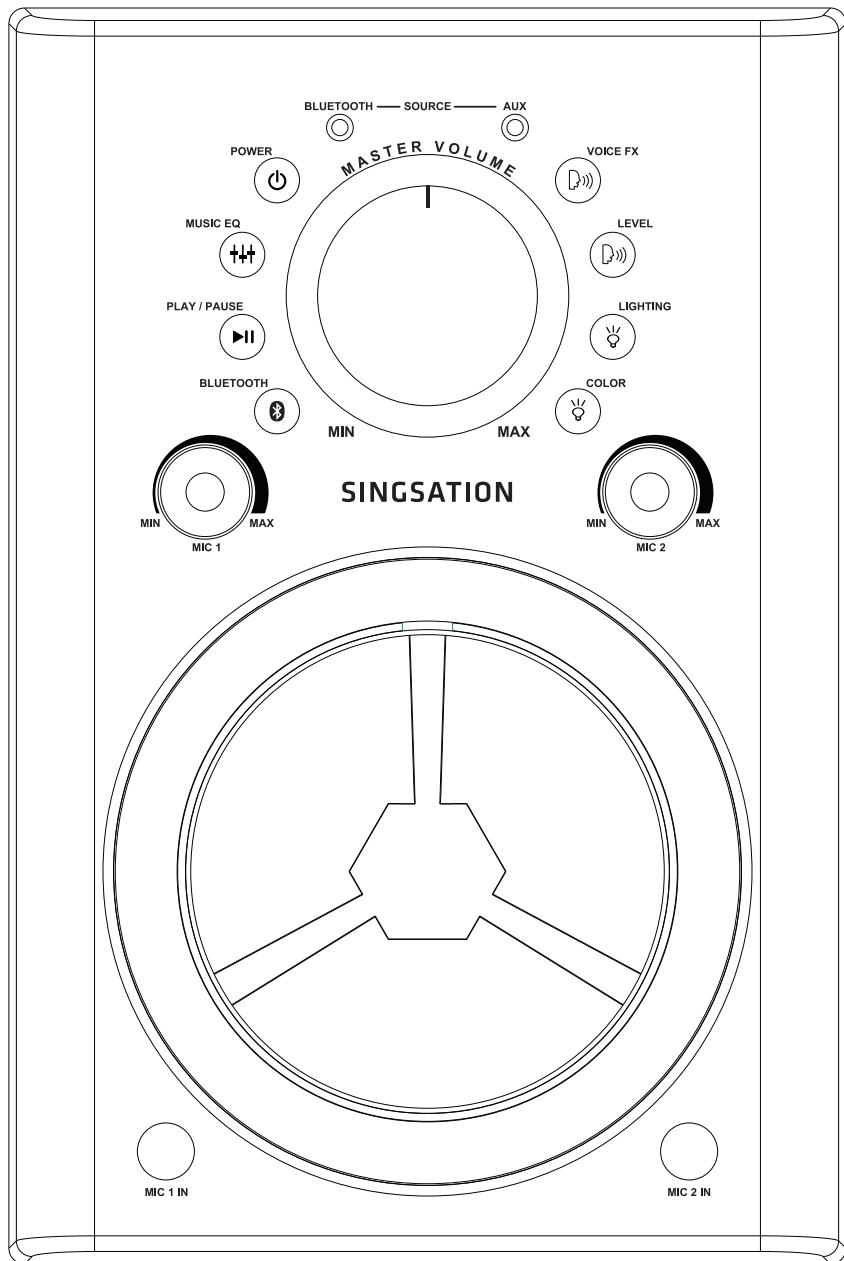
**Indicador BLUETOOTH:** muestra el estado Bluetooth del Singsation Classic (continuo es conectado; parpadeando rápido significa sincronizando y parpadeando lento significa desconectado).
