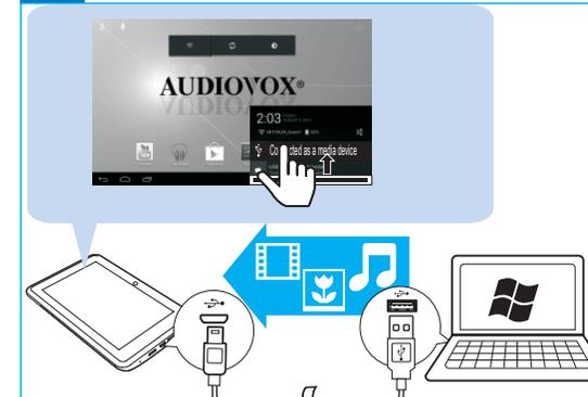
Connecter la tablette T752 à un ordinateur avec le câble USB pour transférer les fichiers entre les dispositifs. Sélectionner Activer le stockage USB et appuyer sur OK pour procéder.
